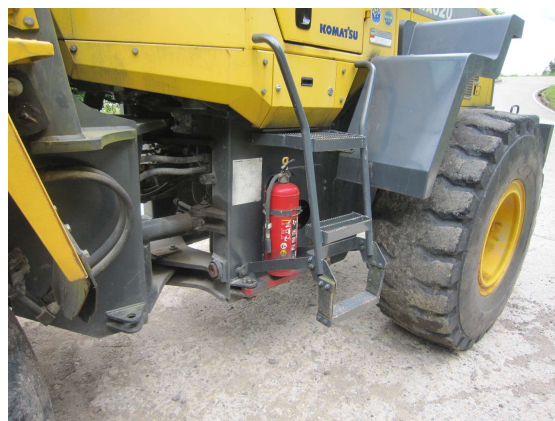
(消火器設置状況)
