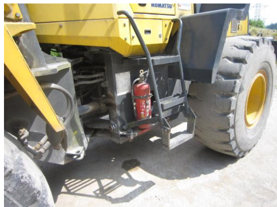
(消火器設置状況)
