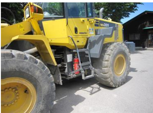
(消火器設置状況)
