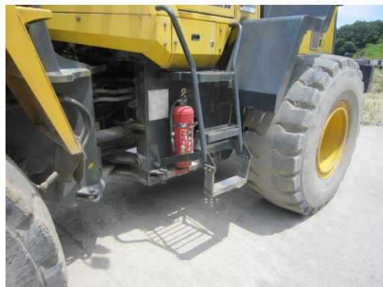
(消火器設置状況)
