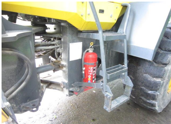
(消火器設置状況)
